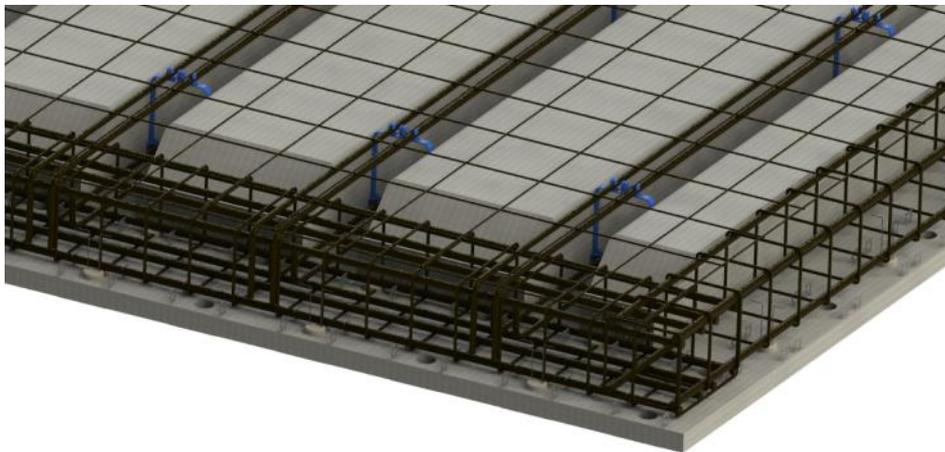
SMART - SLAB CUENTA CON PIEZAS AISLANTES PARA LAS ZONAS MACIZAS, TALES COMO ZUNCHOS, JÁCENAS, ETC., QUE INCORPORAN AL IGUAL QUE EL RESTO DEL SISTEMA PERFILES METÁLICOS SÓLIDAMENTE ANCLADOS A LA ESTRUCTURA PRIMARIA DE HORMIGÓN ARMADO PARA FACILITAR LA APLICACIÓN DE ACABADOS DE YESO LAMINADO U OTROS.
