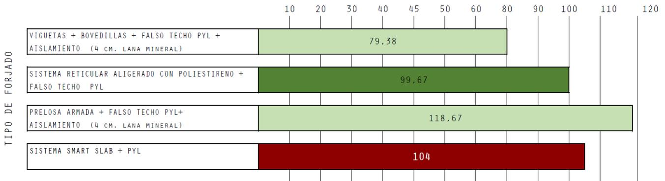
FIGURA 2. GRÁFICO RESUMEN COMPARATIVO ENTRE SISTEMAS DE FORJADOS
